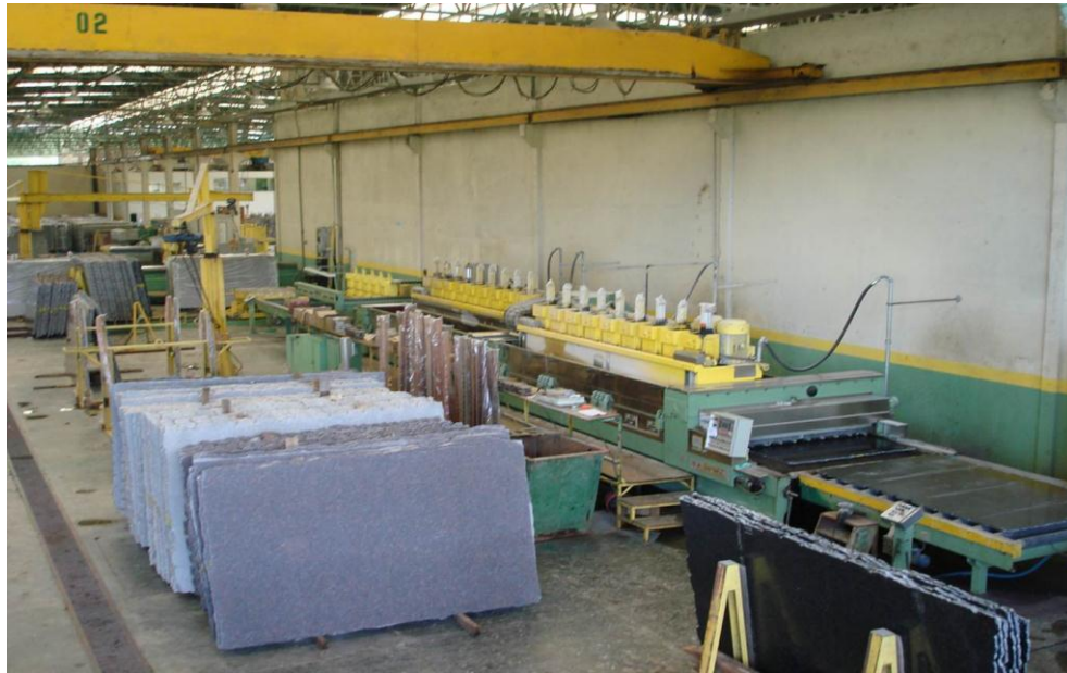
Figura 12 – Setor que abriga as máquinas responsáveis por processos de beneficiamento.
