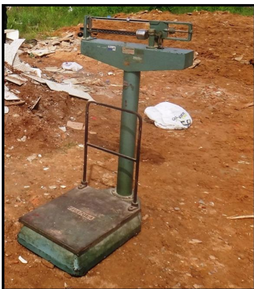
Figura 5 - Balança mecânica com capacidade para 300 kg.
