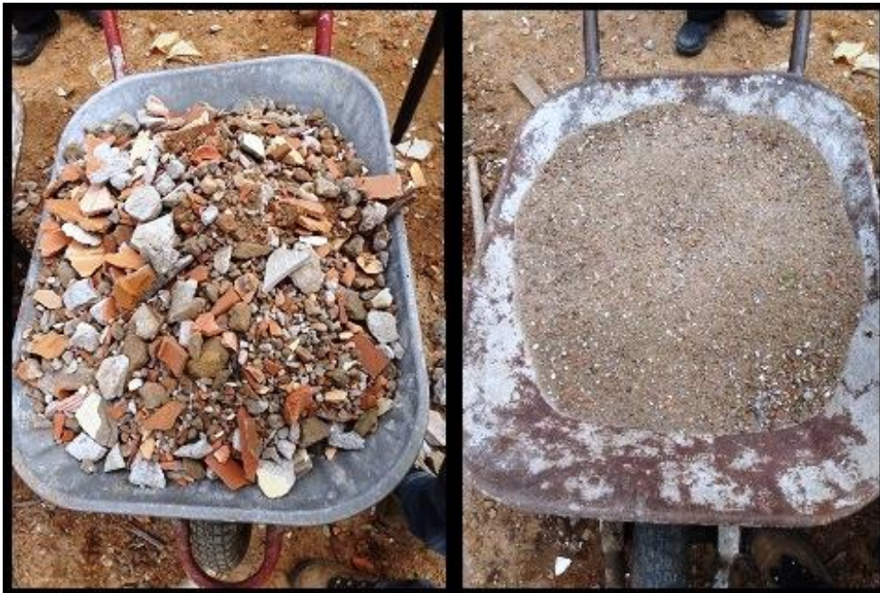
Figura 9 - Caçambas contendo caliça retida e caliça peneirada.
